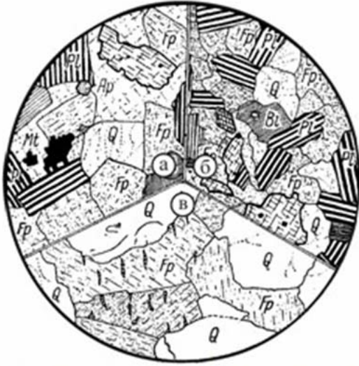
Рис. 79. Гранітова структура (а, б); характерним є ідіоморфізм Qtz як останнього за часом виділення мінералу; гранулітова структура (в), на відміну від гранітової, характеризується ідіоморфізмом Qtz відносно польового шпату. Трапляється у лейкогранітах і аплітах [Деньгин, 1934; рис. 96]
