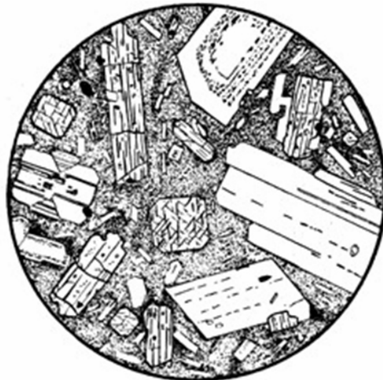
Рис. 61. Андезит енстатитовий. Структура серіально-порфірова. Найпізніші виділення андезину мають скелетні форми. О. м. напівсклувата [Хетч та ін., 1975; рис. 111]
