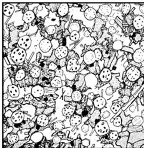
Рис. 110. Лейцитит. Вкрапл.: Lct, Срх, невелика кількість слюди, а також акцесорні Ap і Mag. О.м.: безбарвне скло [Хетч та ін., 1975; рис. 126]
