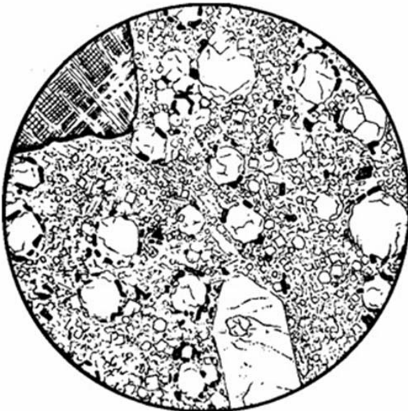
Рис. 121. Лейцитовий фоноліт. У фенокристаллах Lct, Sa (внизу) і Нум (зверху зліва). О. м. складена Ne, Lct і Sa. Трапляється трохи голочок Aeg, які наростають на вкрапл. Lct; d = 2 мм [Заварицький, 1961; рис. 180, а]
