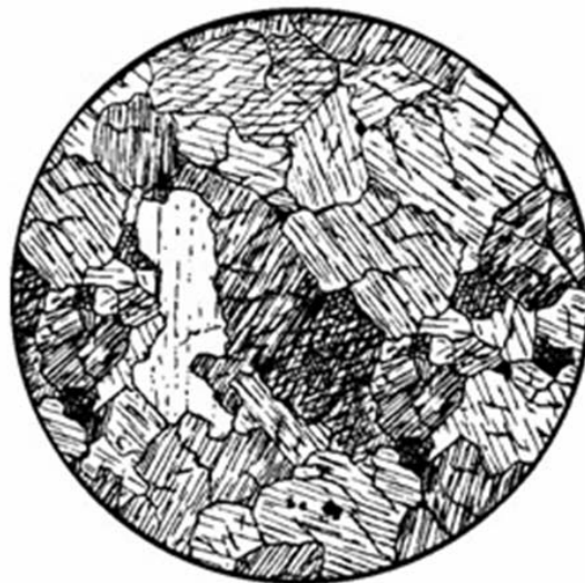
Рис. 25. Горнблендит Hbl, зліва поодиноке зерно Pl; d = 2,3 мм [Заварицький, 1961; рис. 92, б]
