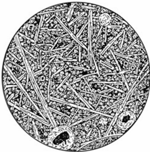
Рис. 47. Базальт. Структура о. м. мікродолеритова: між різковидовженими неупорядковано розташованими індивідами Pl, згромадження малих зерен Срх. Текстура мигдалекамія. У мигдаликах Chl або Chl і рудний мінерал; d = 6,7 мм. Зеленомиський розлом [Лапин, Фролова 1992; рис. 23, а]
