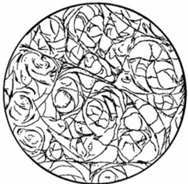
Рис. 90. Перліт. Структура вітрофірова. Кисле скло з характерними перлітовими тріщинами; d = 2,6 мм. [Заварицький, 1961; рис. 138, б]
