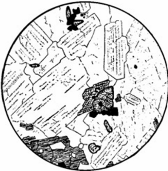
Рис. 73 Гранодіорит. Типова гіпідіоморфна (гранітова) структура Pl, Fsp, Qtz, Hbl і акцесорні Mag і Ttn; d = 3,1 мм [Заварицький, 1961; рис. 122, а]
