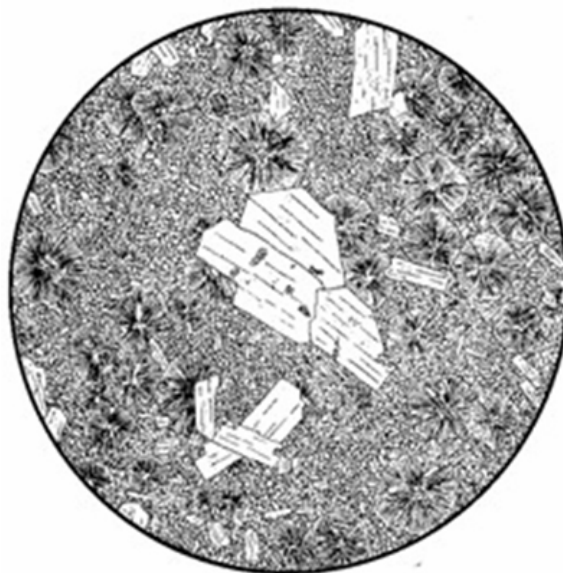
Рис. 92. Фельзит. Порода складена крупними (до 1,5 мм) і дрібними фенокристаллами Pl, псевдоморфозами хлориту по фенокристалах кольорового мінералу і о.м. У мікрофельзитовій о.м. розташовано сфероліти радіально-променистої будови. Структура порфірова зі сфероліто-мікрофельзитовою о.м.; d = 4 мм [Половинкина, 1966, рис. 230]
