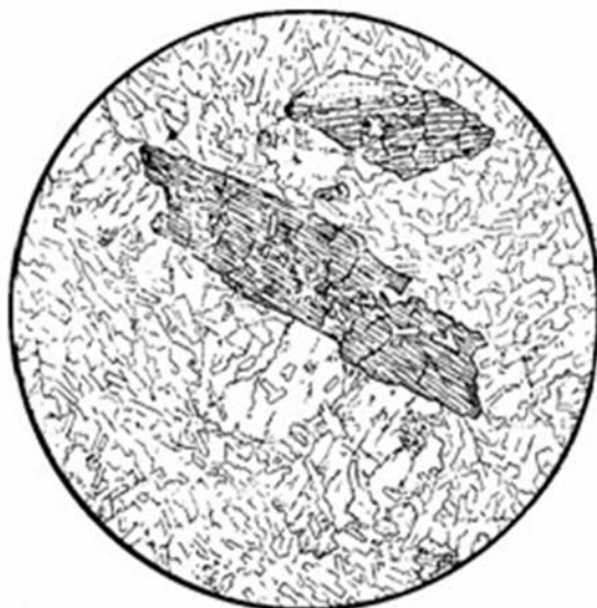
Рис. 114. Маріуполіт. У дрібнозернистий о. м. з лейст Аб вкрапл. Ne і Aeg. Хадакрисали Аб у цих мінералах; d = 4,7 мм [Заварицький, 1961; рис. 170, а]
