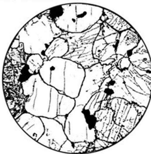
Рис. 102. Ункомпагрит. Зерна зі спайністю – Mel. Зерна без спайності – Ol. В ункомпагриті обов'язковим мінералом є Срх-Di-Aug; на рисунку він не показаний [Саранчина, Шинкарьов, 1967; рис. 104]
