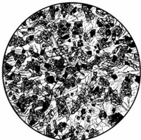
Рис. 68. Шошоніт. Порода дуже дрібнозерниста, повнокристалічна, структура гломеромікропорфірова, авгітофірова і спорадофірова. Фенокристали Aug (0,3-0,4 мм) трапляються лише зрідка. Порода складена кулястими зернами Aug, довгими голочками Pl (до 0,2 мм) рудного мінералу, зрідка лусочок Bt. Проміжки між цими мінералами виповнені Fsp. Структура о. м. є близькою до мікродіабазової; d = 1,6 мм [Половинкина, 1966, рис. 367]
