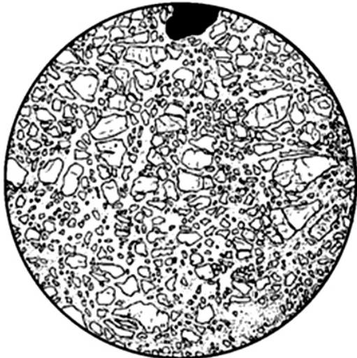
Рис. 10. Дуніт серпентинізований Серпентин (волокнистий хризотил, утворює мережу, в петлях якої «ув'язнюються» реліктові зерна ОІ. Структура петельчаста, у ділянках інтенсивнішої серпентинізації тонковолокниста; d = 4 мм [Половинкина, 1966; рис. 91]
