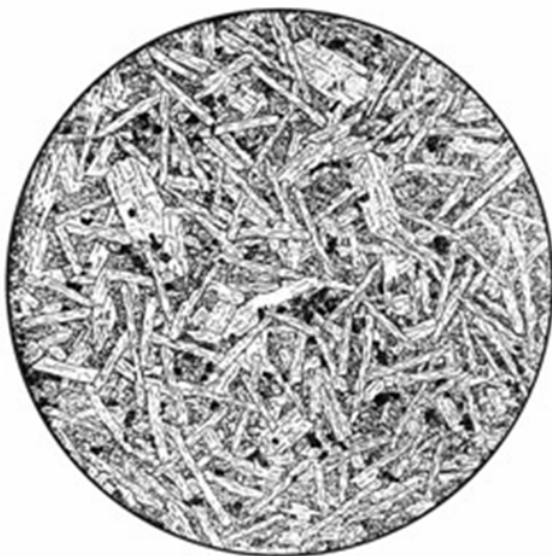
Рис. 49. Спіліт. Структура апоінтерсертальна; d = 4 мм [Половинкина та ін., 1948; рис. 52]
