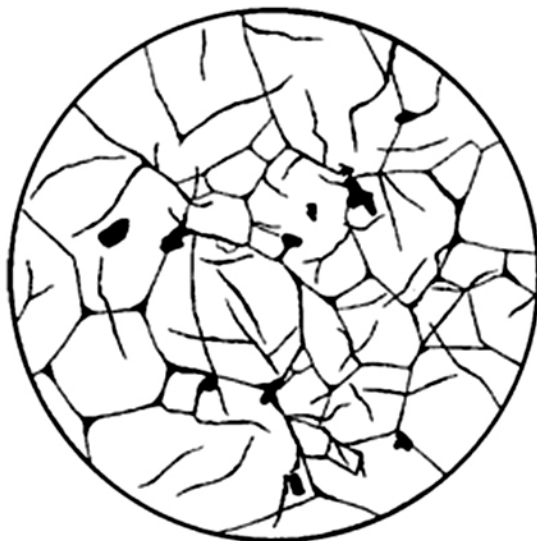
Рис. 8. Олівініт. Структура панідіоморфна. Порода складена свіжими ідіоморфними зернами ОІ з тонкими прожилками Srp та невеликої кількості Mag; d = 2 мм [Половинкина, 1966; рис. 90]
