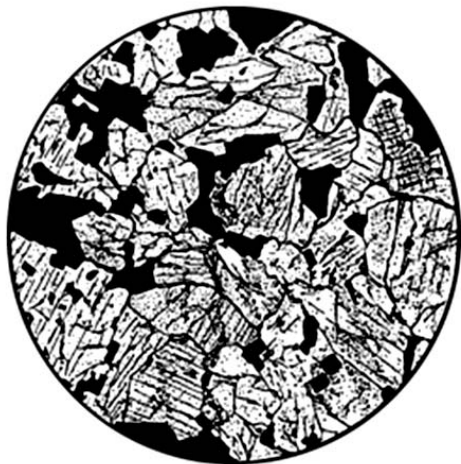
Рис. 94. Якупірангіт. Фіолетово-бурий Tiaug, Mag. Сидеронітова структура; d = 1,7 мм [Заварицький, 1961; рис. 91, а]
