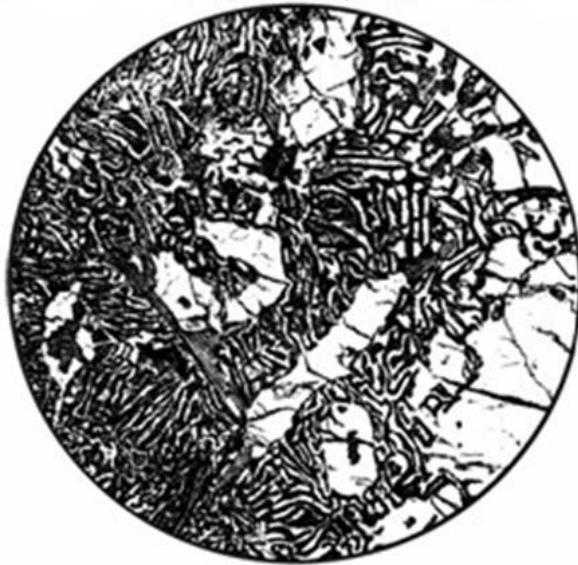
Рис. 118. Ділянка шліфу фельдшпатоїдного сієніту, у якому Fsp інтенсивно проростає червоподібними дуже тонкими вростками Ne. У шліфі видно зерна Fsp (біле), які не проросли нефеліном, Bt і рудний мінерал. Структура дактилоскопічна; d = 1,8 мм [Половинкина, 1966, рис. 318]
