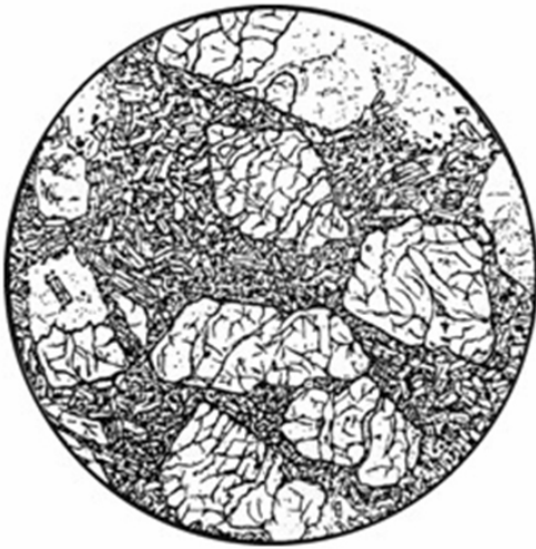
Рис. 20. Меймечит. Олівіноофітова структура. Вкрапл. частково-серпентинізованого ОІ у мікролітовій о.м. – Срх, Маг невелика кількість скла; d = 4 мм [Заварицький, 1961; рис. 104]
