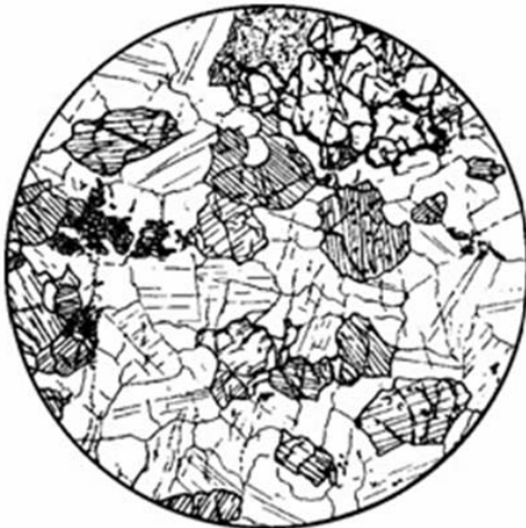
Рис. 32. Олівіновий норит. Орх (бронзит), Ol (зверху) та основний Pl. Невеликі групки сосюриту (зліва). Типова габроофітова структура; d = 7 мм [Заварицький, 1961; рис. 55, а]
